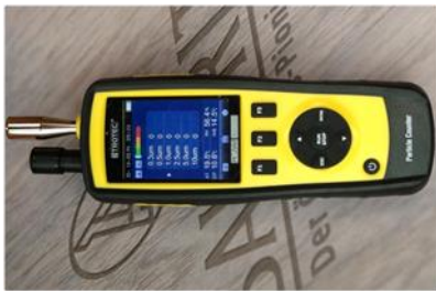
Abb. 1: Partikelzähler Trotec PC200
