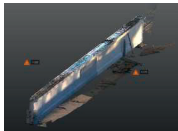
Abb. 10: Punktwolke des gescannten Binders
