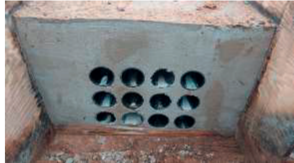
Abb. 2: Ansicht der Kopfseite vom Versuchsfeld Flüssigboden
