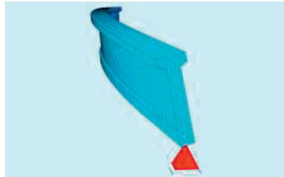
Abb. 11: Verformungsfigur unter Eigenlast
