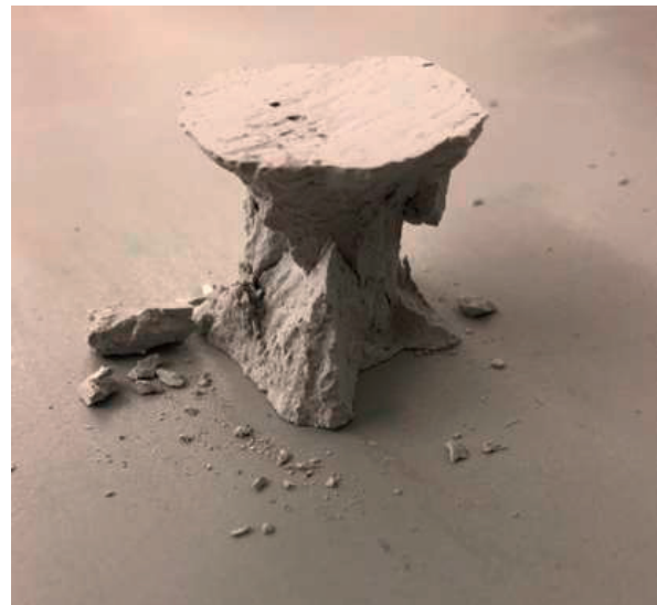
Abb. 2: Prüfkörper nach Durchführung des einaxialen Druckfestigkeitsversuchs
