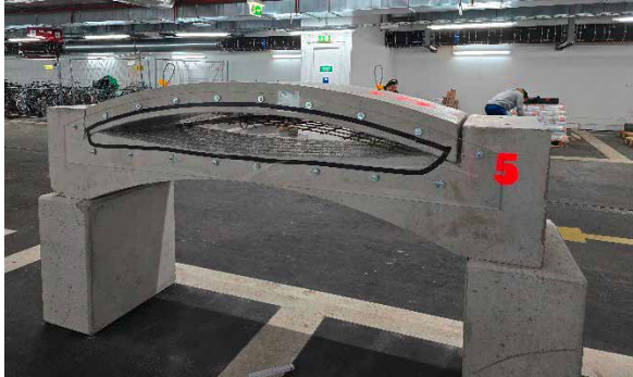
Abb. 2: Testkörper Nr. 5 mit Hohlstelle 20cm
