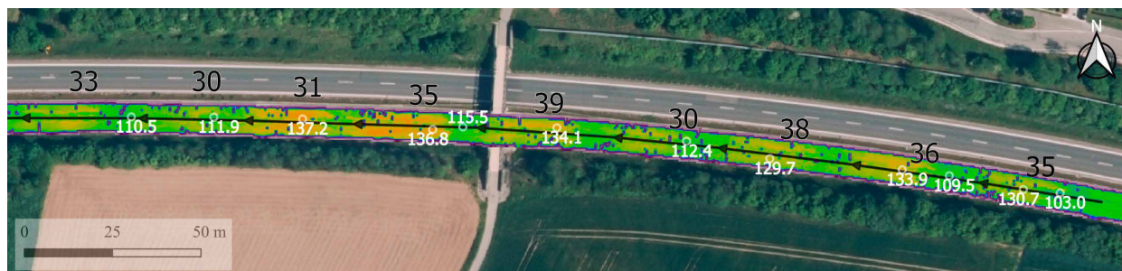
Abb. 1: Darstellung der Lkw-Wechsel im Thermoscan; schwarze Zahlen entsprechen den Distanzen zwischen kühleren Zonen in m, weiße Zahlen entsprechen den Temperaturen in °C.
