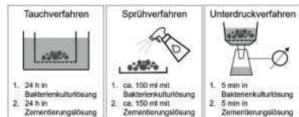
Abb. 3: Schematische Darstellung der Biozementierungs-Behandlungsmethoden
